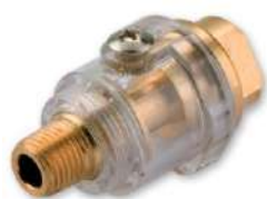
102-065-985 Oleador Lubrificação automática Entrada de Ar: 1/4"NPT Saída de Ar: 1/4"NPT Tamanho: 50mm
