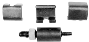
102-350-45 Extrator do eixo piloto da embreagem e trava do platô Monza e Kadett até 92
