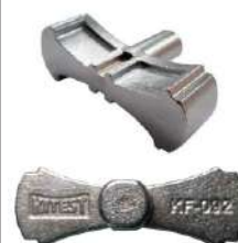
002-015 Ferramenta p/ posicionar em PMS polias do comando de válvulas
