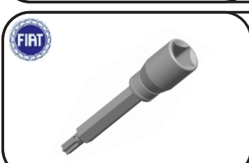
102-345-141372 Chave 3/8" p/ parafuso da tampa superior do comando de válvulas, do motor de arranque e do platô de embreagem FIAT
